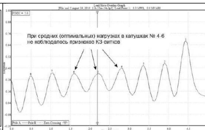
**Рисунок 3В** – При средних нагрузках, где чувствительность для обнаружения КЗ-витков в катушках № 4-6 максимальная, в этих катушках не наблюдалось признаков КЗ-витков
